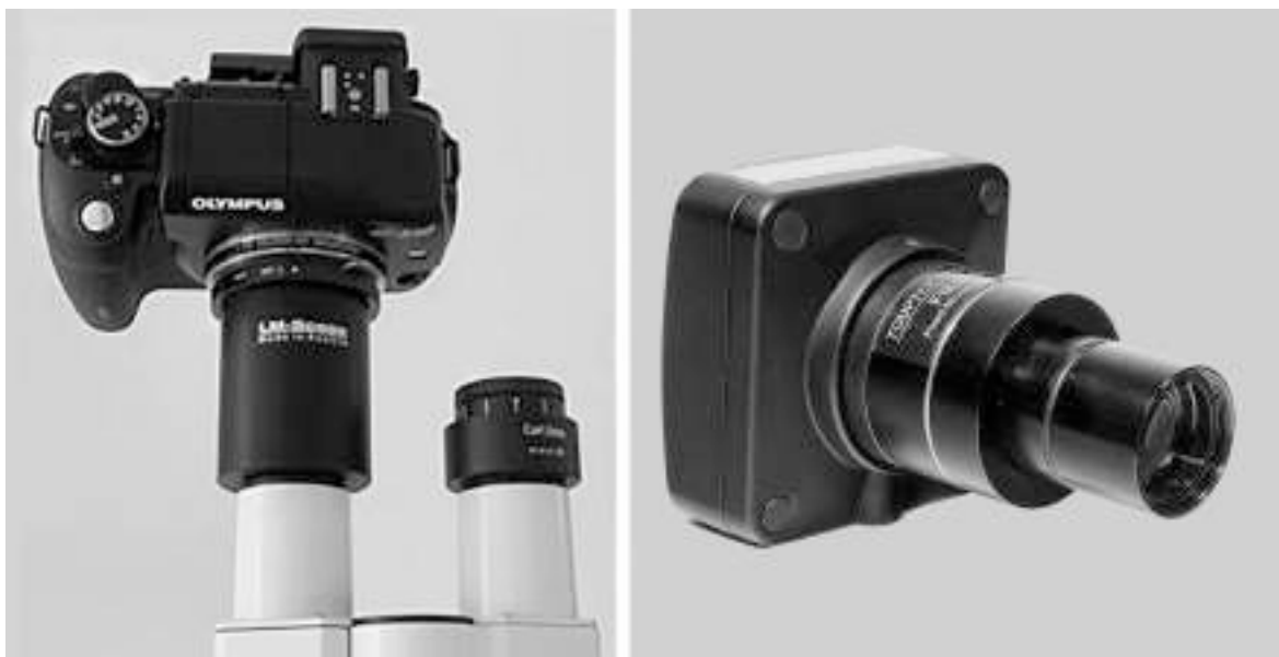
Рис. 19.2. Цифровые фотоокуляры: фотоокуляр ф. Olympus (слева) и видеоокуляр GoProCam 1,31 Мп (справа) [12].
