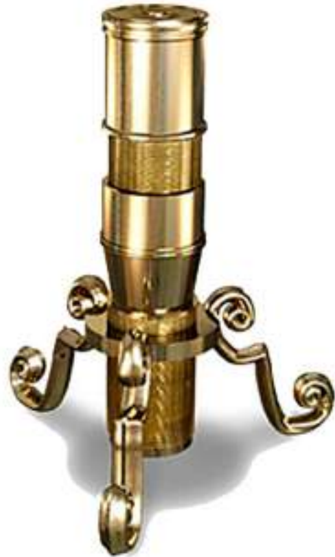
Рис. 2.6. Телескоп Галилея (слева) и итальянский микроскоп конца XVII века, называемый «микроскопом Галилея» (справа) и состоящий из положительного объектива и отрицательного окуляра [45, 77].
