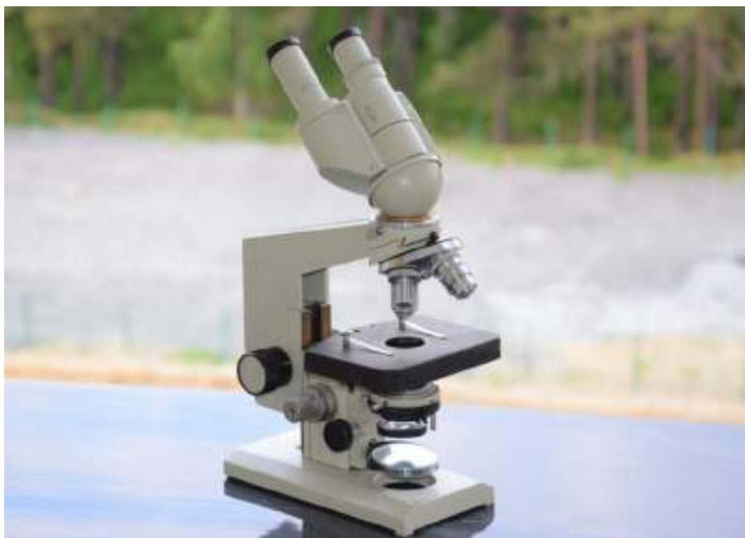
Рис. 11.1. Микроскоп Биолом С3 фирмы ЛОМО. Бинокулярный биологический микроскоп Биолом С3 предназначен для учащихся и студентов, проводящих исследования прозрачных препаратов в проходящем свете в светлом поле при увеличении от 84 до 1350 крат.
