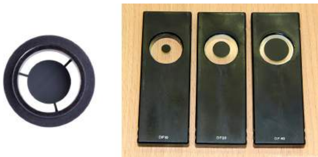
Рис. 13.5. Кольцевая диафрагма (слева) и специальные слайдеры с кольцевыми дисками, применяемые с объективами 10, 20 и 40 крат (микроскоп Jenamed, Zeiss).
