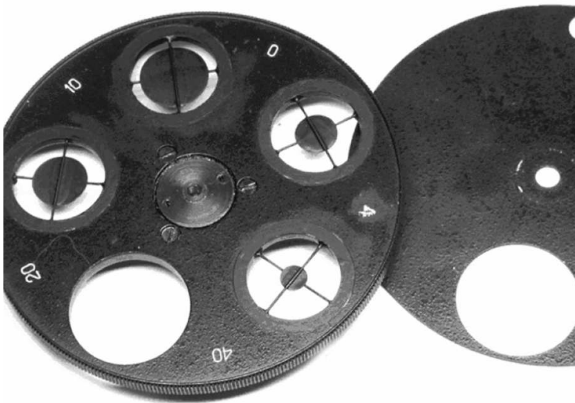
Рис. 12.2. Держатель конденсора с кольцевыми вставками различного диаметра [30].
