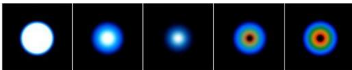
Рис. 8.21. Цветные каёмки, наблюдаемые при наличии хроматической aberrации.
