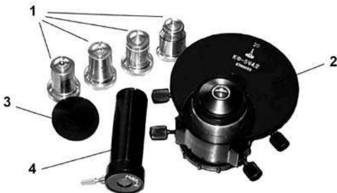
Рис. 14.10. Общий вид фазово-контрастного устройства КФ-5 ф. ЛОМО. 1 – комплект фазовых объективов: 20 \times 0,40 ; 40 \times 0,65 ; 70 \times 1,23 , 90 \times 1,25 ; 2 – конденсор; 3 – светофильтр; 4 – вспомогательный микроскоп МИР-4 [88].
