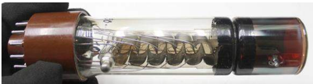
Рис. 20.18. Фотоэлектронный умножитель, модель ФЭУ-29 [12].
