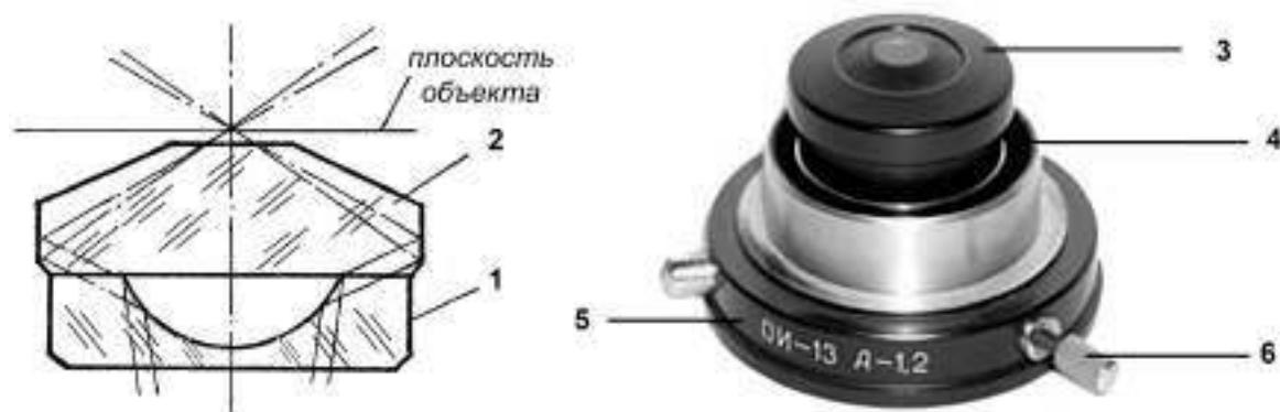
Рис. 13.2. Схема (слева) и внешний вид (справа) специального темнопольного конденсора ОИ-13 производства ЛОМО [69]
