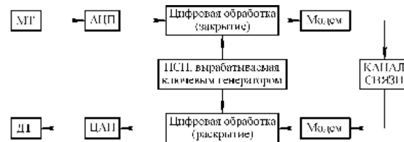
Рис. 3.32. Структурная схема линии связи с цифровым шифрованием: МТ – микрофон телефона, ДТ – динамик телефона, АЦП – аналого-цифровой преобразователь, ЦАП – цифроаналоговый преобразователь, ПСП – псевдослучайная последовательность
