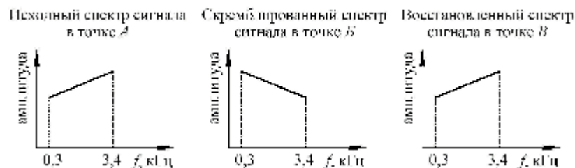
Рис. 3.28. Частотные спектры исходного, скремблированного и восстановленного сигналов при частотной инверсии
