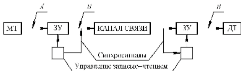
Рис. 3.30. Структурная схема линии связи с временным скремблированием: МТ – микрофон телефона, ДТ – динамик телефона, ЗУ – запоминающие устройства
