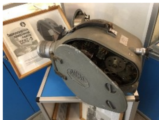
Высокоскоростная кинокамера для исследования траектории полета снаряда
