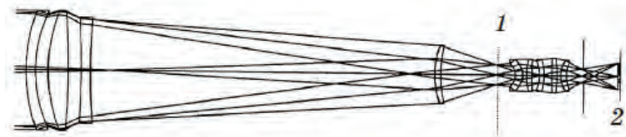
Рис. 1. Оптическая схема крупногабаритного многоспектрального объектива
