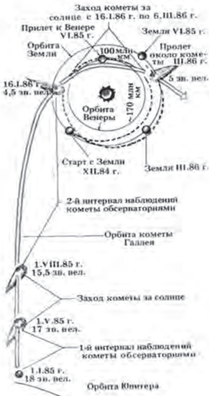
Рис. 1. Схема полета станции «Вега» к Венере и комете Галлея
