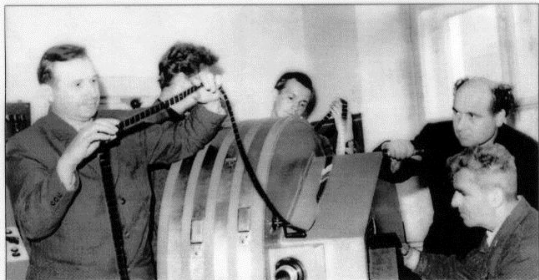
1960 г. Закончился очередной эксперимент с разработанной на кафедре оптико-механических приборов сверхскоростной киносъемочной камерой ССКС-3, обеспечивавшей частоту съемки 300 тыс. кадров в секунду. Руководитель разработки – профессор И.И. Крыжановский (слева), рядом с ним инженер И.В. Венатовский, доцент Н.А. Дьяков, старший инженер П.Н. Макеев, механик Н.В. Жуков
