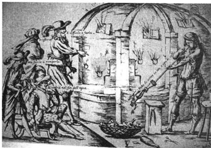
Рис. 6. Печь для варки стекла. Из собрания музея стекла в Мурано, Венеция. Фото авторов.
