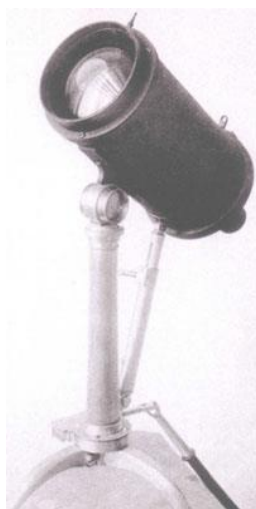
Менисковый Грегори №1. Изготовленный мастерскими ГОИ в Йошкар-Оле "прямо с колёс". Он кочевал с Максутовым повсюду, пока после смерти Дмитрия Дмитриевича не нашёл пристанище в музее Пулковской обсерватории. Йошкар-Ола, 1942 г[4]
