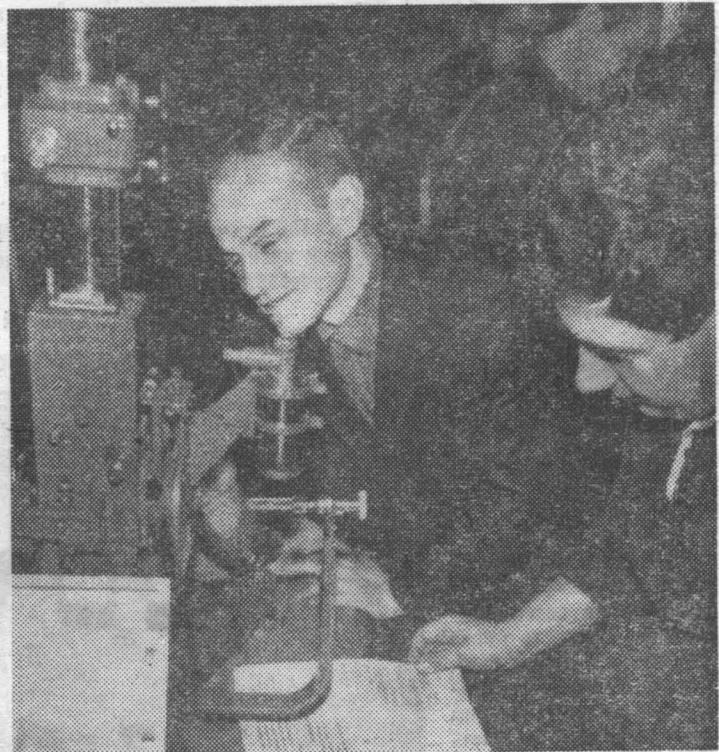
Лабораторная работа на кафедре оптико-механических приборов. Студенты 531-й группы Григорий Эпштейн и Феликс Беккер за регулировкой универсального коллиматора стационарного типа.
