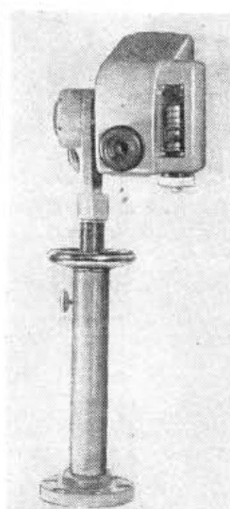
Прибор располагается на расстоянии 6 метров от оси поковки на мостице кузнеца-бригадира, на специальной тележке. Тележка перемещается вдоль направляющих, расположенных параллельно оси поковки. Таким образом, бригадир может производить измерения диаметров в любом сечении поковки.
