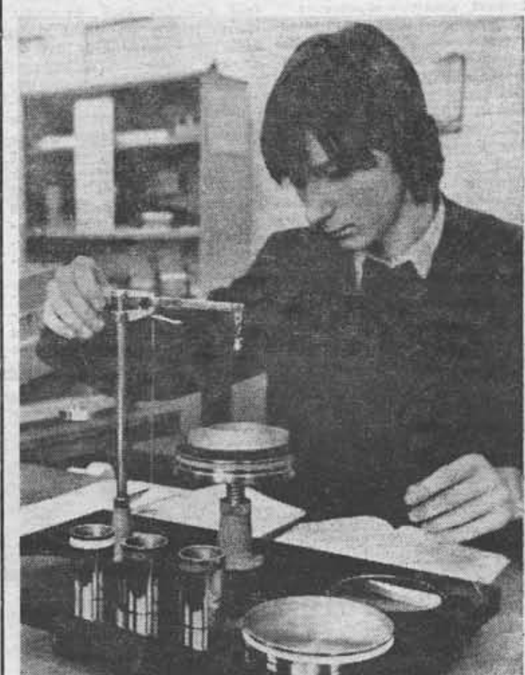
Учебные занятия на кафедре физики. Студент 140-й группы Андрей Рухлин определяет коэффициент поверхностного натяжения методом отрыва кольца.
