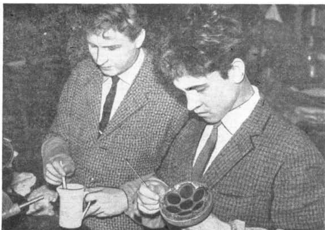
Практические занятия в лаборатории технологии стекла. Студенты 431-й группы Олег Чуканов и Владимир Спиридонов овладевают полировкой и шлифовкой оптических деталей.
