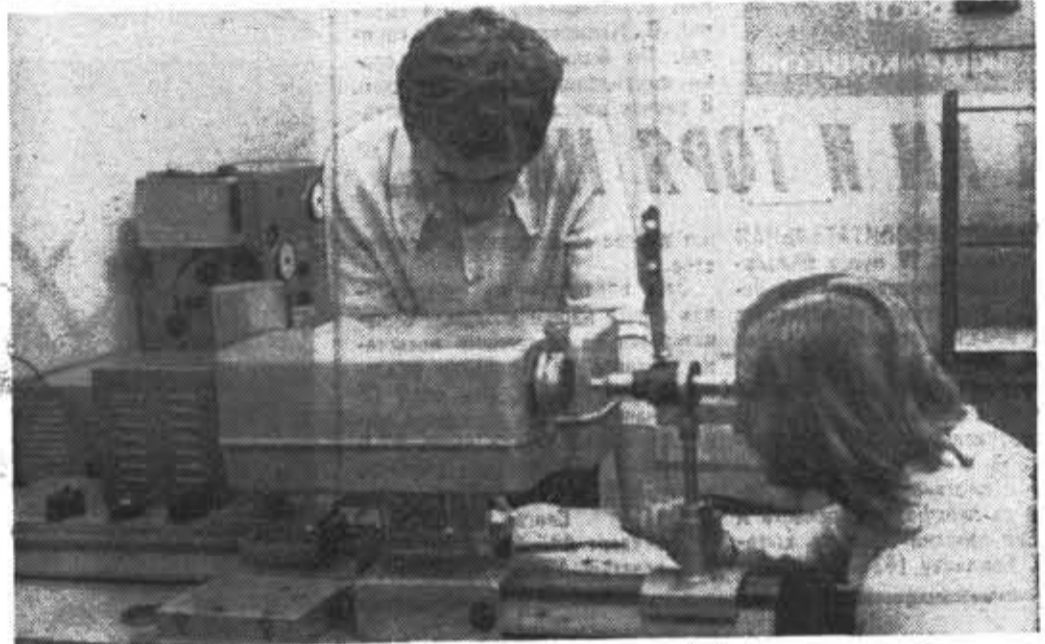
В лабораториях института. Третькурсники факультета оптико-механического приборостроения Лариса Стефанович и Александр Каширский за градуировкой монохроматора. Фото З. Саниной
